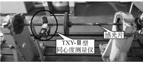
图 13 百分表测量转子弯曲实物图
